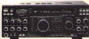
YAESU FT-1000/FT-990 2 VFO - 100 kHz - 30 MHz - All Mode - 100 memorie - 200 W RF (FT 990 100 W RF) - Accordatore automatico di antenna - Alim. 220 V.
