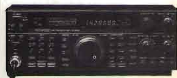
KENWOOD TS 450 S/AT - 690 S/AT Copre le bande amatoriali da 100 kHz a 30 MHz (50-54 MHz TS 690 S/AT) - All Mode - Tripla conversione DTSS - Step 1 Hz - Accord. aut. - Filtro selez. - 100 memorie - Indicatore digitale a barre - Speak processor audio - Display LCD multifunzione - Alim. 13,8 V.
