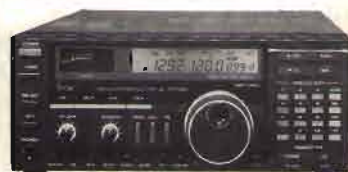
ICOM IC-R7100 - Ricevitore a largo spettro freq. da 25 MHz a 1999 MHz - All Mode - Sensibilità 0,3 - μvolt - 900 memorie.
